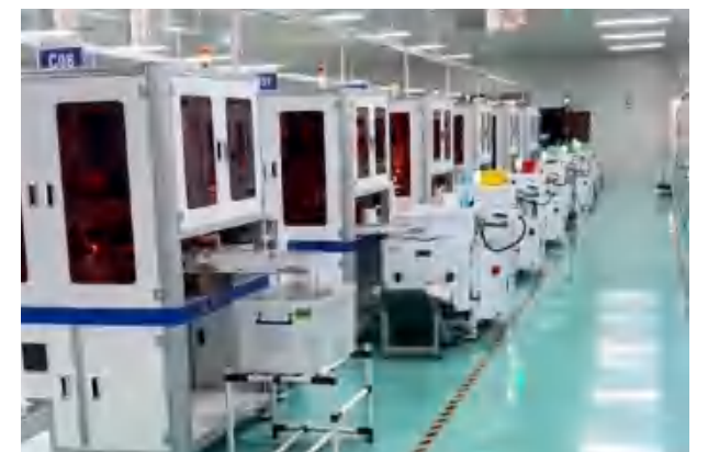
CCD挑选机(螺纹360°)
